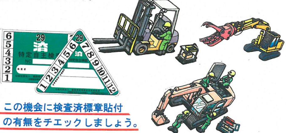
なお、車両系建設機械等を使用する事業者は、労働安全衛生法第45条により1年以内に1回、有資格者（特定自主検査事業内検査者又は、特定自主検査登録検査業者）による検査を実施することが義務づけられています。【※法改正により平成25年7月1日よりコンクリート解体機（鉄骨切断機・コンクリート圧碎機・解体用つかみ機）が新たに対象となりました。】
